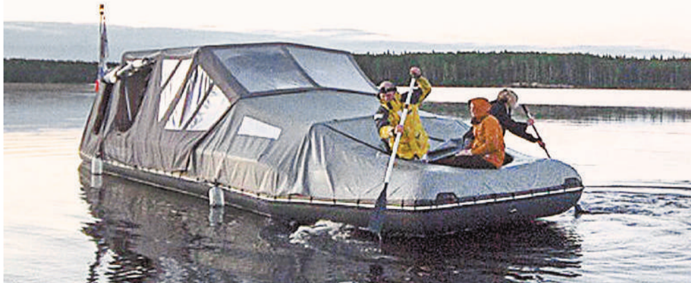
В Беломорске завершились ходовые испытания надувного экспедиционного судна «Кашалот» (на фото слева). Это самая большая надувная лодка в мире. Её длина 11,3 м, ширина 3,3 м. Грузоподъёмность 2,5 т. На борту могут находиться 8 человек. Конструировалась лодка специально для экспедиции по Амазонке протяжённостью 7000 км — от истока в верховьях Перу и до устья, где река впадает в Атлантический океан.
