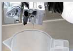
Рисунок 1. Слить масло из нового компрессора и определить его объем.
