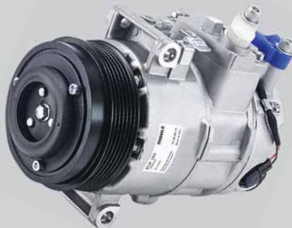
Рисунок 1. Слить масло из нового компрессора и определить его объем.
