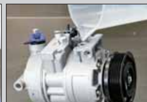
Рисунок 2. Заправить компрессор требуемым объемом масла и вновь закрыть его.
