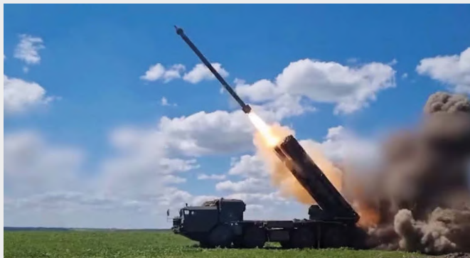
Расчёт РСЗО 9К515 «Торнадо-С» ведёт огонь с применением 300-мм управляемого реактивного снаряда 9М542 или 9М544.
