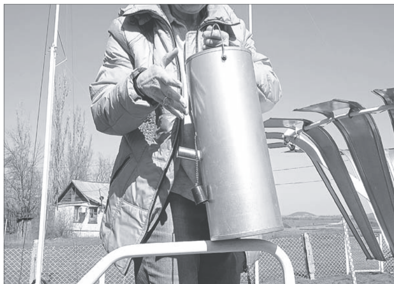
Раз в сутки осадкомер опорожняют и проверяют, сколько задержалось воды.
