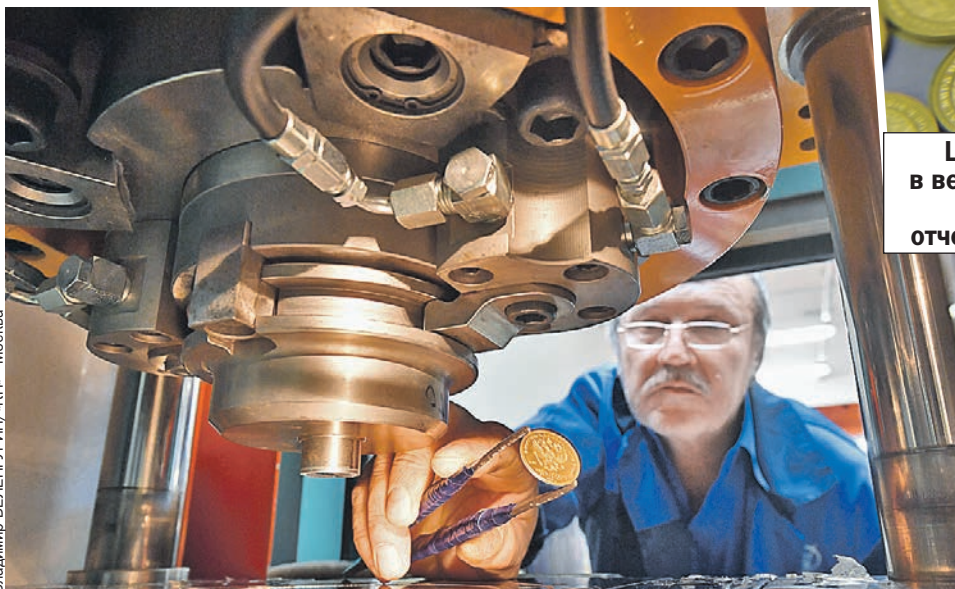
Каждую памятную монету из драгметаллов штампуют вручную. Это позволяет добиться более высокого качества.
