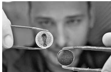
Вот из такой заготовки (справа) после процесса чеканки появляется готовая монета стоимостью 40 тысяч рублей.
