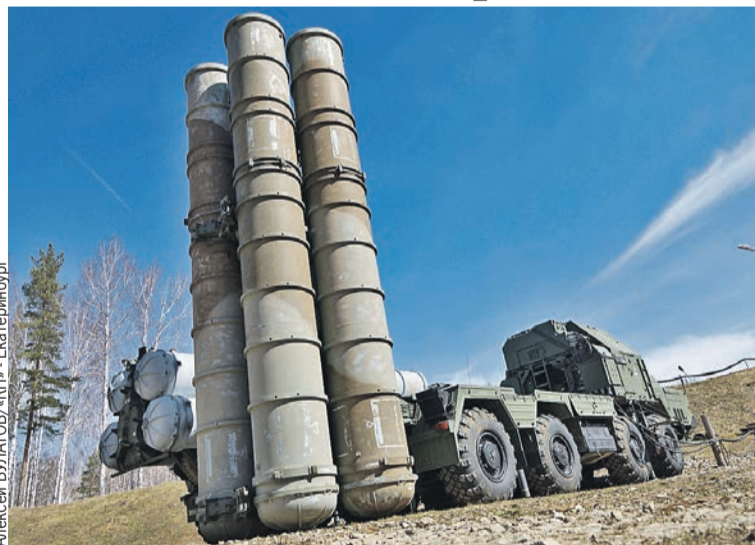
Зенитный ракетный комплекс С-300 «Фаворит» считается одним из лучших в мире. Он может полностью автономно наводить до 72 ракет на цели с расстояния до 200 километров. И, конечно, точно их поражать.
