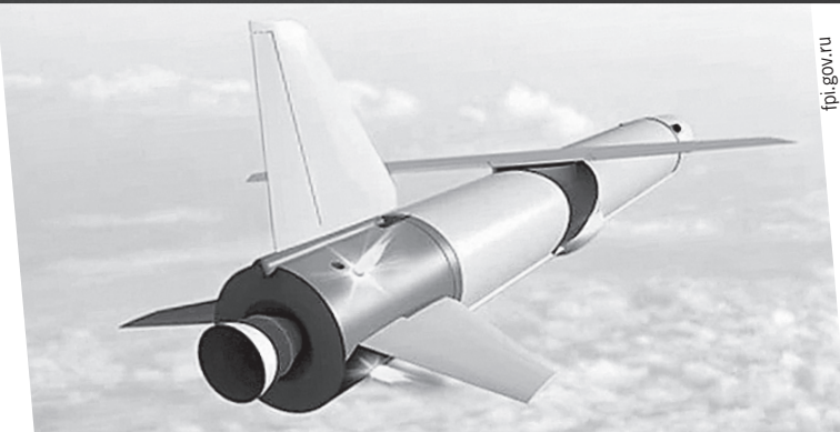
Многоразовая ракета «Крыло-СВ», по планам, должна приземляться не вертикально, а как самолет.
