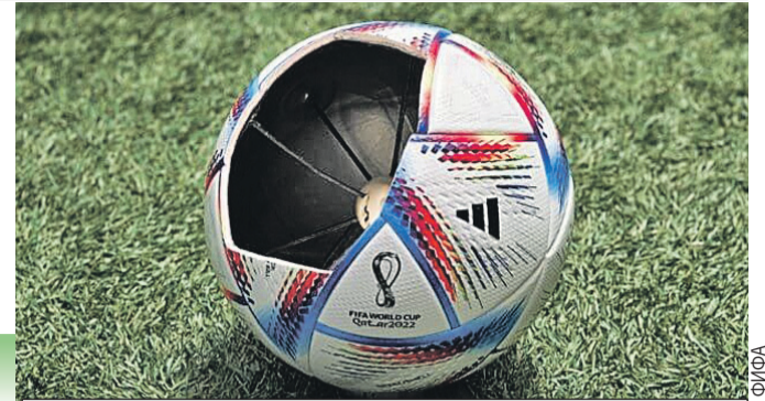
В центре сферы расположен датчик, который показывает не только положение мяча на поле, но и силу удара по нему.
