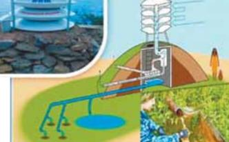
Установка для извлечения пресной воды из воздушного потока.
