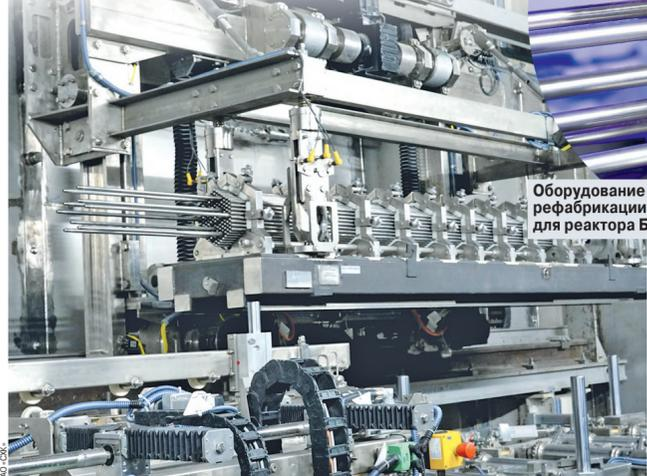
Оборудование модуля фабрики/рефабрикации ядерного топлива для реактора БРЕСТ-ОД-300.
