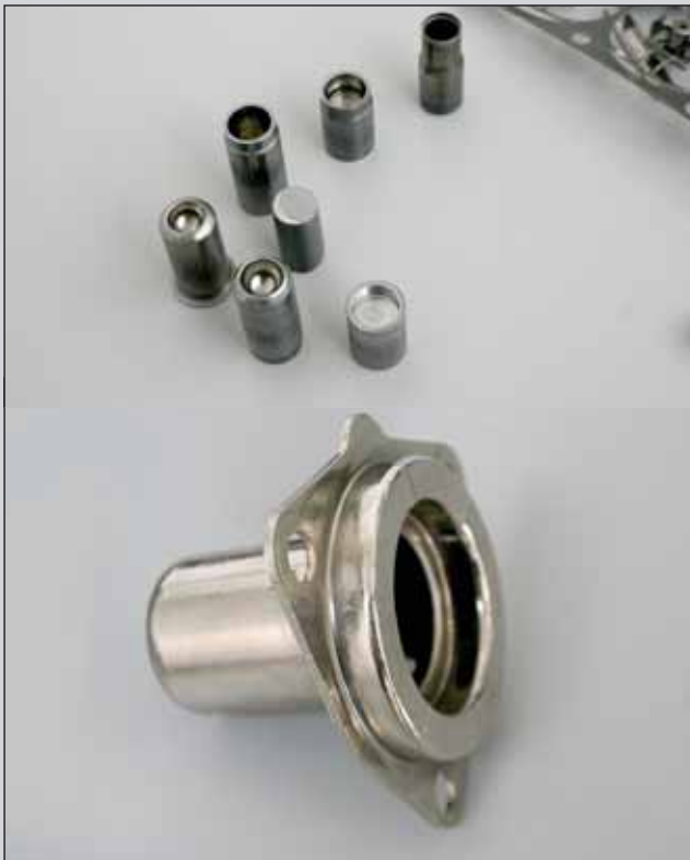
Требуется всего несколько ударов пресса, чтобы из куска металлического стержня получилась готовая деталь.
