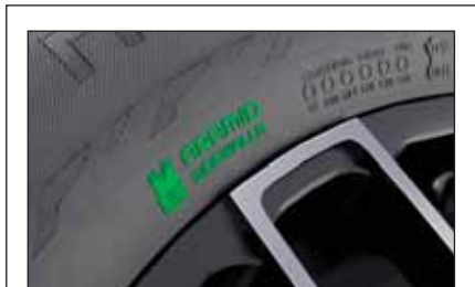
Усиленная боковина шины сделана из резиновой смеси с добавлением арамидных волокон.
