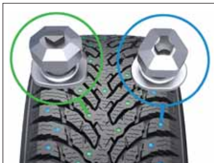
Разные по форме сердечника шипы установлены в центральной и боковой частях протектора.
