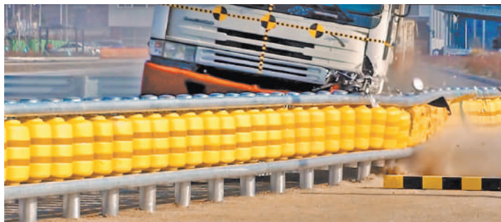
На дорогах в Южной Корее уже появляются новые гибкие отбойники.
