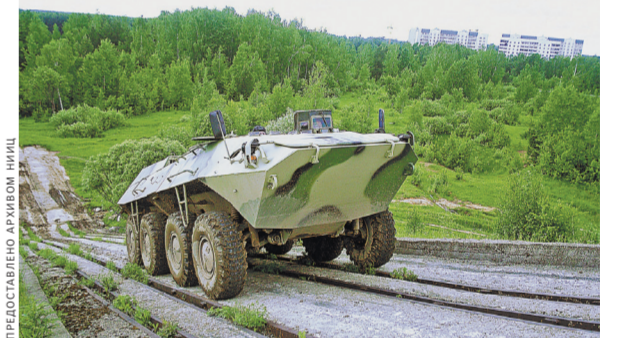
«Электрический» БТР на испытаниях в Кубинке. Преодолевает подъем в тридцать градусов.
