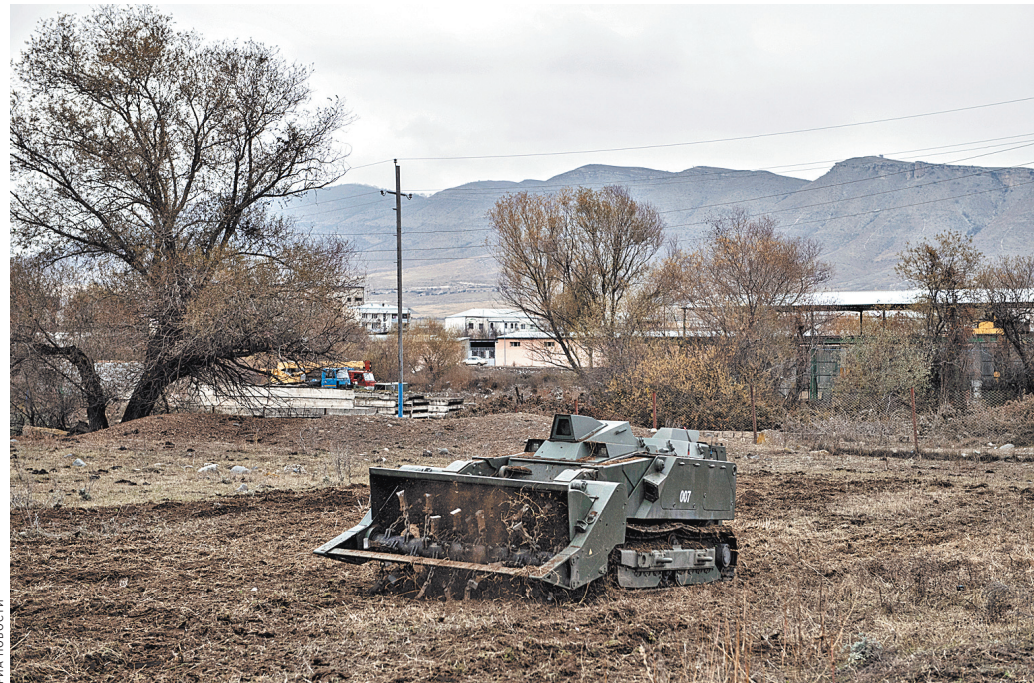
Оператор может управлять инженерным комплексом «Уран-6» с расстояния до 800 метров.
