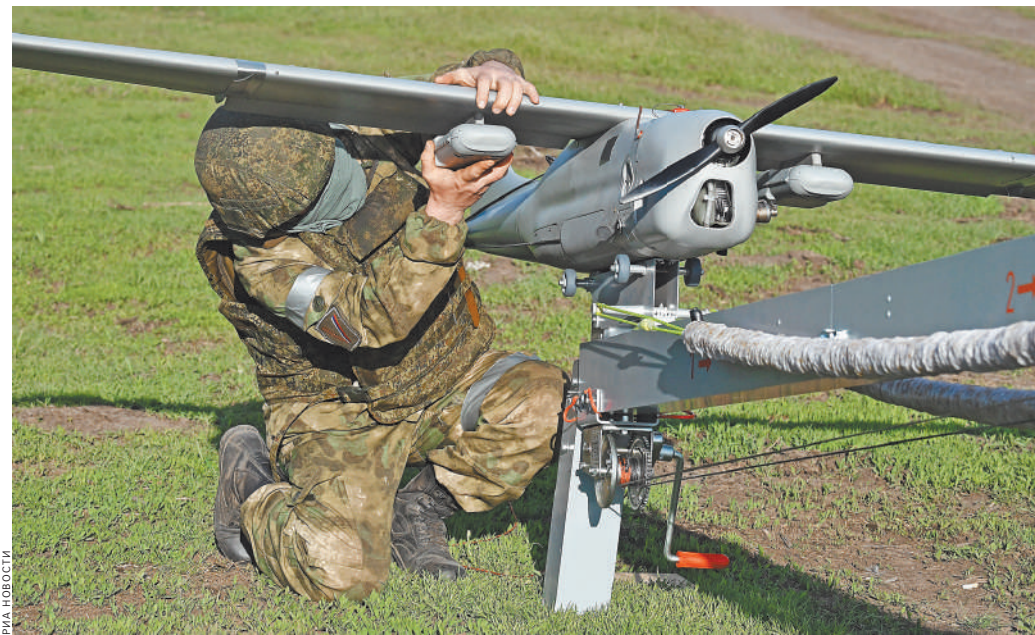
Беспилотник «Орлан-10» может нести боеприпасы, которые крепятся под крыльями в специальных контейнерах.
