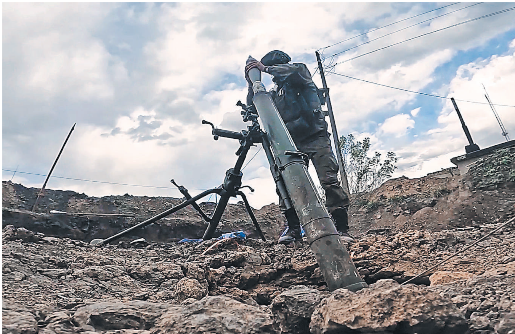
120-мм миномет 2С12 «Сани», который наши военные используют в ходе спецоперации, можно развернуть практически в любом месте и выполнять с закрытой позиции до 10 выстрелов в минуту.
