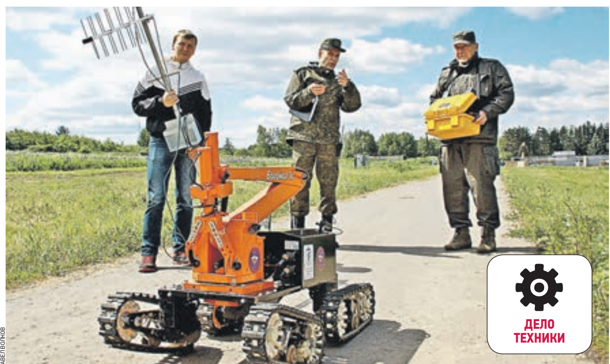
Вчера 13:35 Красноармейск. Робот «Богомол» — уже «ветеран» Российской армии. 11 лет такие машины помогают проводить разведку на местности и обезвреживать взрывные устройства
