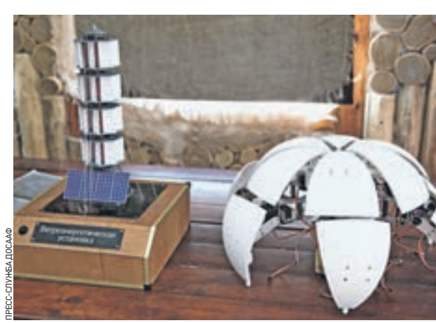
Шаровая платформа, позволяющая роботам спускаться по лестнице и пересекать труднодоступные участки местности
