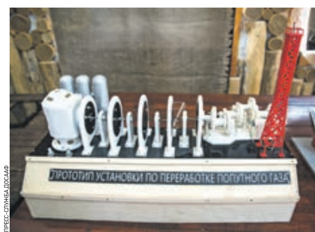
Прототип установки по переработке попутного газа, которую сейчас создает компания «Газпром»
