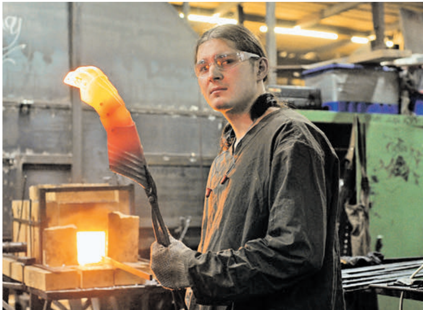
Кузнец Анатолий Потемни проверяет, равномерно ли нагрелась заготовка. Эта процедура очень важна: недогретую сталь намного сложнее ковать, а в случае перегрева изделие будет хрупким и даже может сломаться еще при ковке
