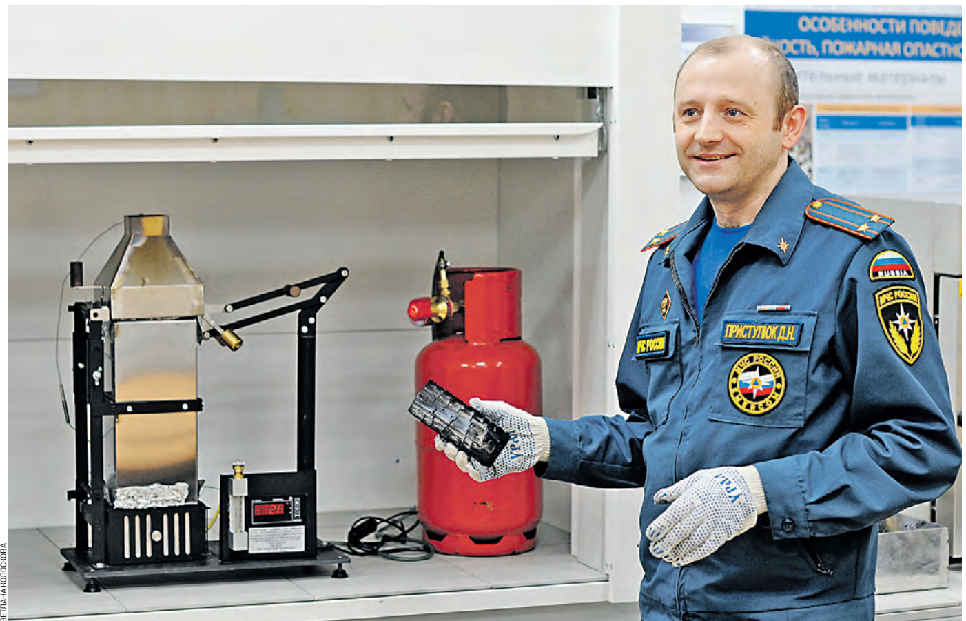
23 апреля 15:24 Начальник кафедры «Пожарная безопасность в строительстве» Академии МЧС России Дмитрий Приступок демонстрирует установку, которая определяет эффективность огнеупорных растворов для древесины
