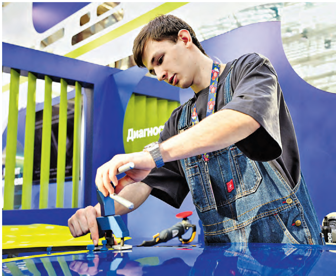
21 марта. Студент 4-го курса Московского автомобильно-дорожного колледжа Александр Бобровский устраняет вмятины на кузове автомобиля. фото: ПЕЛАГИЯ ЗАМЯТИНА
