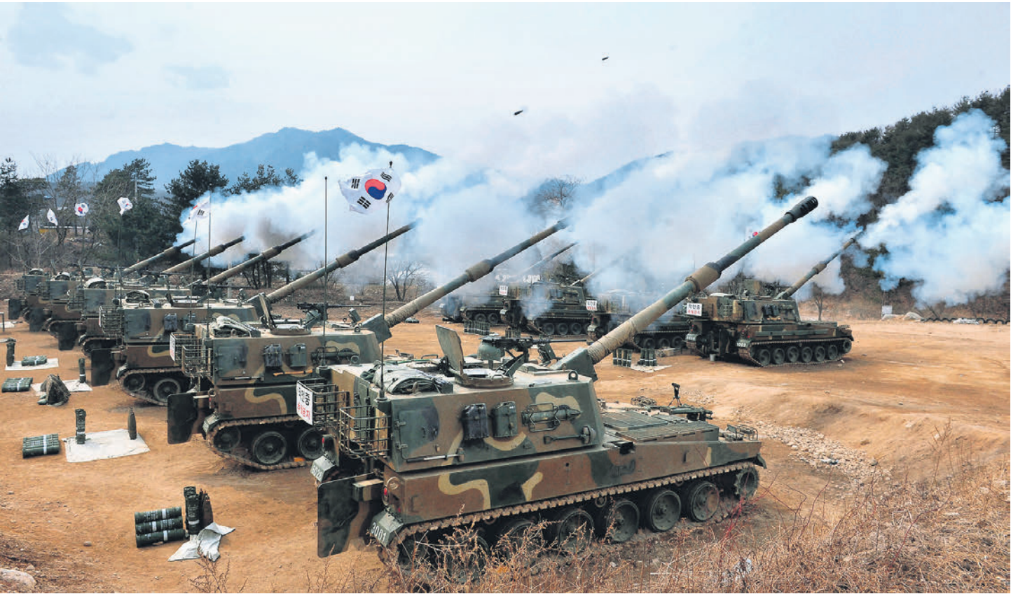
В число наиболее популярных на мировом рынке образцов южнокорейских вооружений входят самоходные гаубицы K9. Их собирают примерно за 180 дней, в два-три раза быстрее, чем аналогичное вооружение у конкурентов, и они стоят около $3,5 млн, что минимум на треть дешевле, чем в целом по рынку
