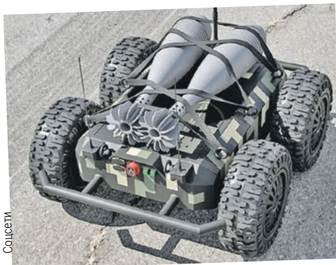
Робот Ratel S может доставлять до двух противотанковых мин ТМ-62 со скоростью более 20 км/ч.
