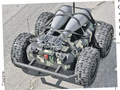
Робот Ratel S может доставлять до двух противотанковых мин ТМ-62 со скоростью более 20 км/ч.
