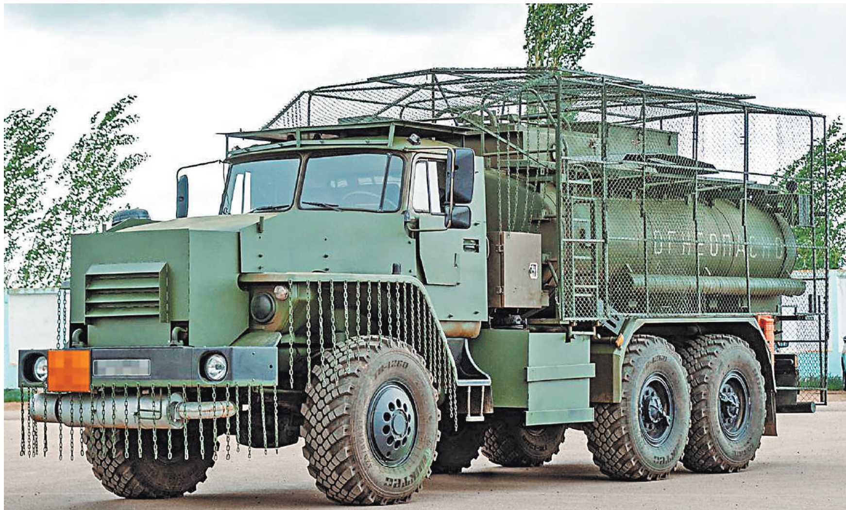
Бензовозы спецназа Росгвардии оборудовали защитой от осколков и дронов. Металлические цепи, сетки и навесы приварили к грузовикам сотрудники машиностроительной компании «Витязь» (входит в «Уралвагонзавод»). Они оснастили антидроновой и противоосколочной защитой два бензовоза, которые уже поступили в отряд спецназа Росгвардии, выполняющий боевые задачи в зоне специальной военной операции. В ближайшее время на предприятии будут оборудованы дополнительной защитой еще несколько таких машин.
