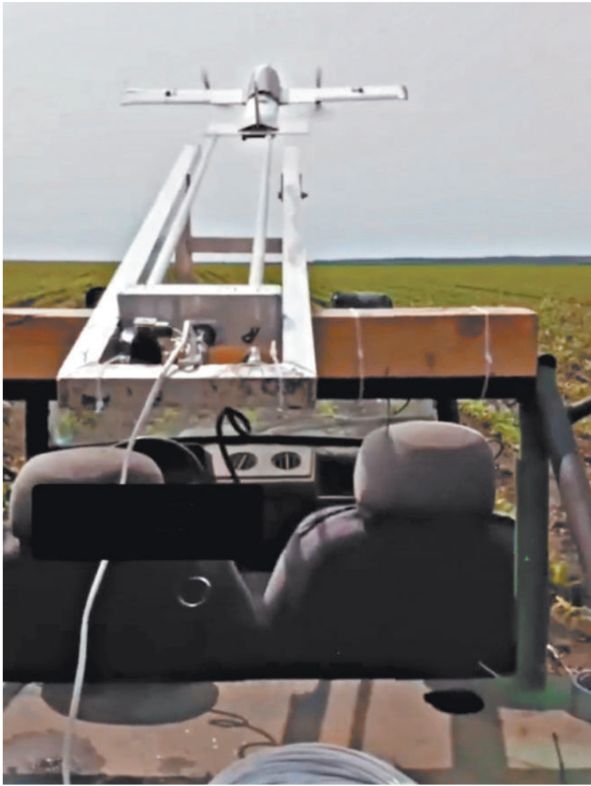
Российские бойцы-умельцы превратили компактный автомобиль VAZ-1111 «Ока» в пусковую установку для дронов-камикадзе «Молния». На опубликованном видео показан запуск дрона самолетного типа с автомобиля в зоне СВО прямо во время движения. Бойцы предусмотрительно лишили «Оку» крыши и дверей, которые заменили каркасом безопасности. На нем закрепили специальную катапульту для удобства запуска дронов-камикадзе. Дроны «Молния» за последнее время уничтожили несколько украинских танков и бронемашин.
