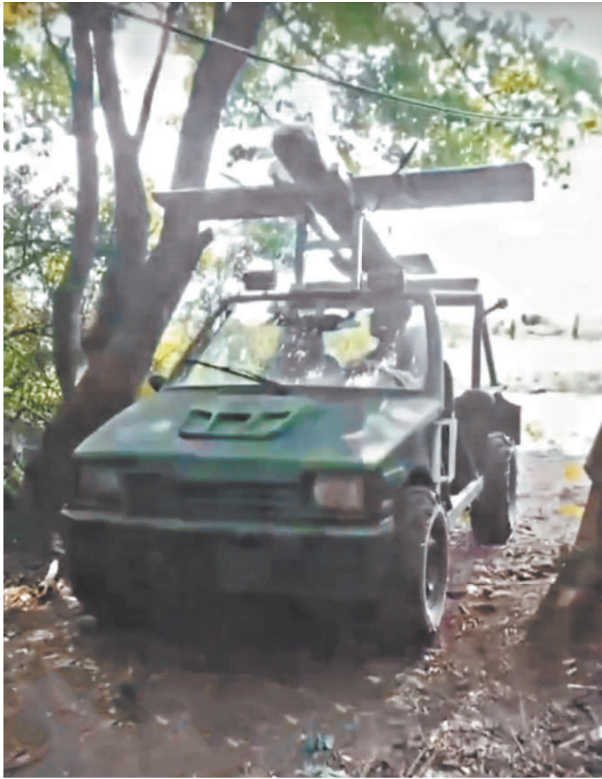
Российские бойцы-умельцы превратили компактный автомобиль VAZ-1111 «Ока» в пусковую установку для дронов-камикадзе «Молния». На опубликованном видео показан запуск дрона самолетного типа с автомобиля в зоне СВО прямо во время движения. Бойцы предусмотрительно лишили «Оку» крыши и дверей, которые заменили каркасом безопасности. На нем закрепили специальную катапульту для удобства запуска дронов-камикадзе. Дроны «Молния» за последнее время уничтожили несколько украинских танков и бронемашин.
