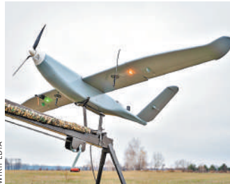
БПЛА самолетного типа звучат похоже на мопед или газонокосилку.
