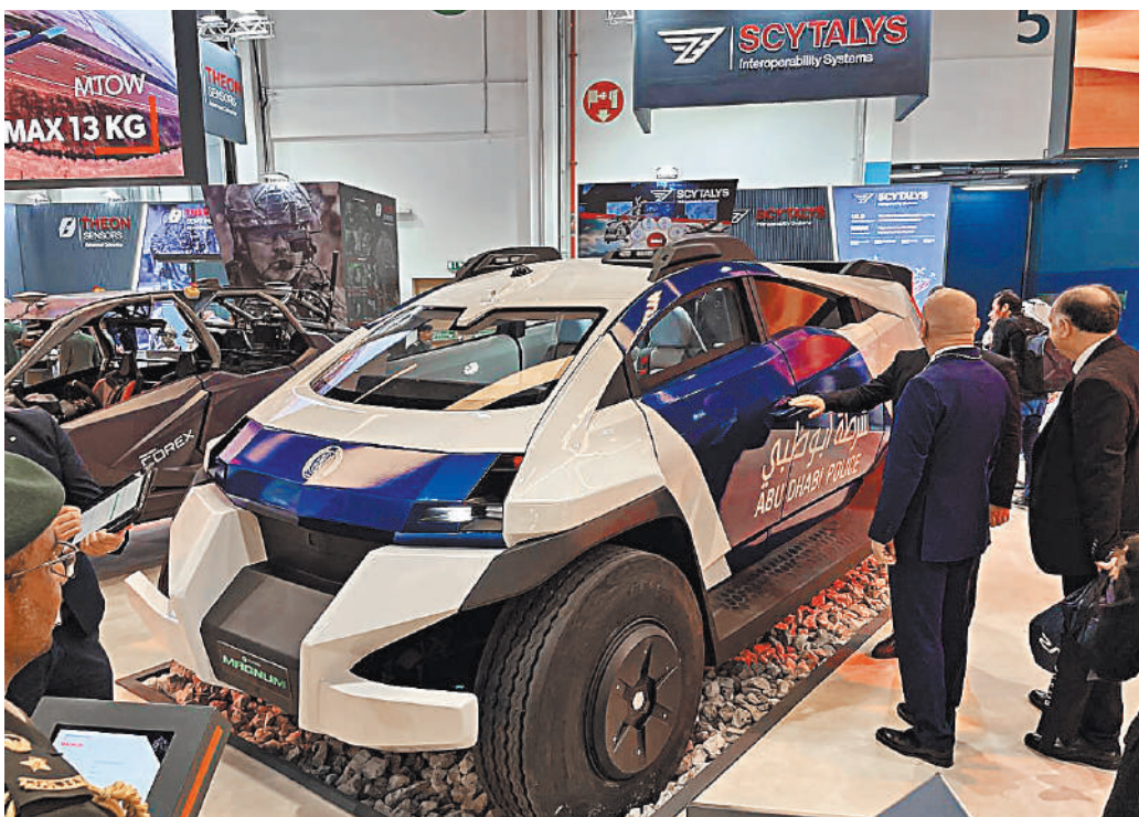
Полицейский вездеход Magnum, разработанный в ОАЭ, способен запускать дроны на ходу через крышу.
