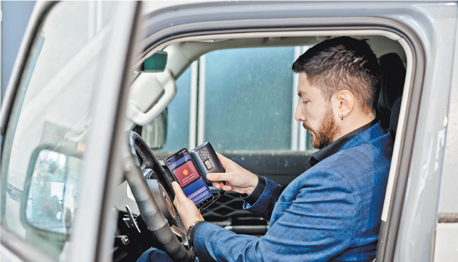
Так выглядит устройство: в одной руке прибор, перед которым нужно выдохнуть, в другой—смартфон. Он покажет результат. В запечатленном случае водитель тест не прошел.
