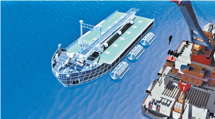
Затонувшие суда будут поднимать со дна с помощью коффердамов (специальных инженерных сооружений) и после полной откачки оставшегося в танкерах мазута.
