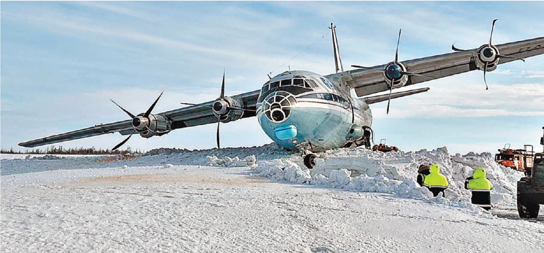
Сломалась левая стойка шасси, Ан-12 выкатился со взлетно-посадочной полосы и увяз в сугробе.
