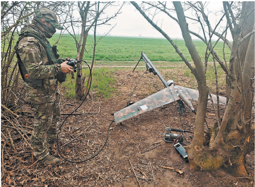
Для запуска дрона Zala нужна катапульта. Но она занимает немного места, и взлет можно провести с любой точки.
