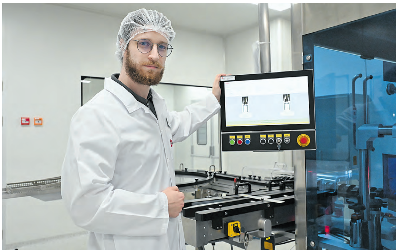
23 июля. Ведущий инженер-технолог предприятия — резидента ОЭЗ «Технополис Москва» Валентин Менча показывает оборудование, которое помогает определить качество флакона с фармацевтическим препаратом. ФОТО: МАРИЯ ХАПЦОВА
