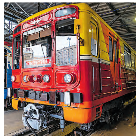
Диагностический поезд «Синергия-2» помогает проверять геометрию рельсовой колеи
